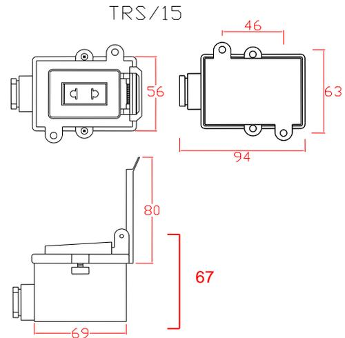
**CUERPO:** Estructura de duraluminio inyectado. Stove bolts galvanizados de 5/32". Tomacorriente o Interruptor marca BTicino de 15 Amp. Pintura al horno color gris martillado.
