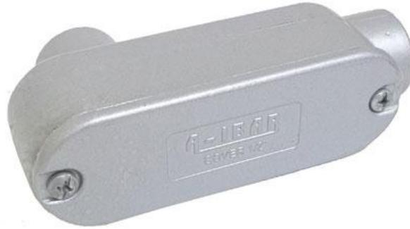
**CUERPO:** Caja y Tapa de estructura de aluminio fundido inyectado, muy buen acabado y resistente a impactos. Para conexiones de ½” NPT. Pernos galvanizados de 5/32”.
