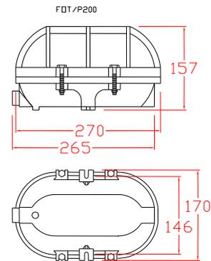
**CUERPO:** Estructura de aleación de Aluminio fundido. Pintura al horno color gris martillado para mejor protección del producto. Instalación eléctrica por medio de 1 o 2 salidas con prensaestopas o para conexión de tubería de ½" NPT.
