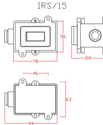
**CUERPO:** Estructura de duraluminio inyectado. Stove bolts galvanizados de 5/32" Ø. Interruptor o tomacorriente BTicino de 15 Amp. Pintura al horno color gris martillado.
