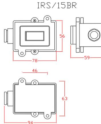
**CUERPO:** Estructura de bronce fundido y bronce laminado. Stove bolts galvanizados de 5/32" Ø. Dado interruptor marca BTicino de 15 amperios.
