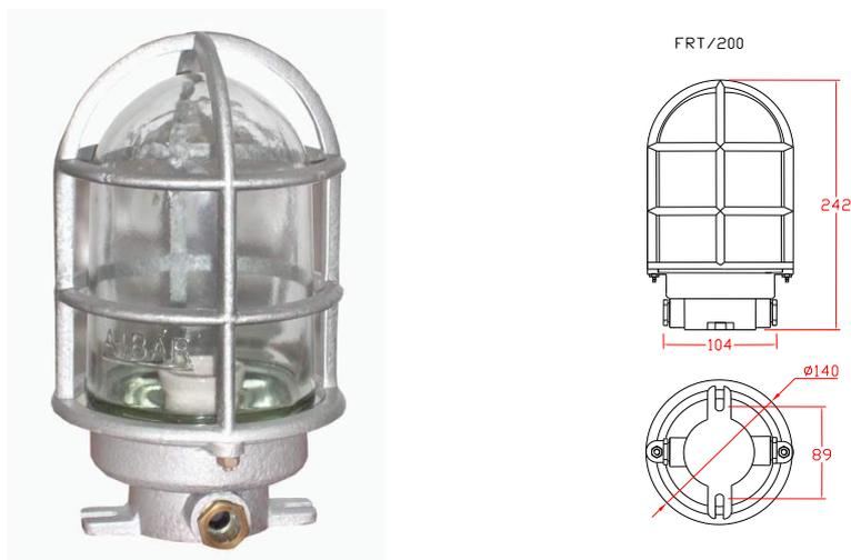
**CUERPO:** Estructura de aleación de Aluminio fundido. Pintura al horno color gris martillado. Instalación eléctrica por medio de 1 ó 2 salidas de ½ NPT
