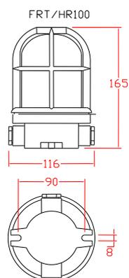
**CUERPO:** Estructura de aleación de duraluminio. Pintura al horno color gris martillado. Instalación eléctrica por medio de 1 ó 2 salidas, para prensaestopas de bronce o conexión con tubos 1/2" NPT. Rejilla y base roscadas (No se necesitan pernos)
