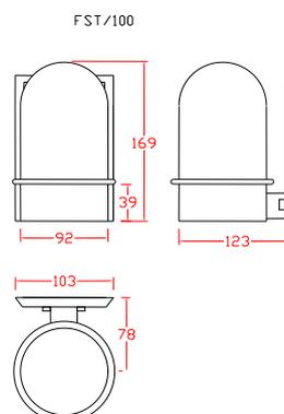
**CUERPO:** Estructura de aleación de Aluminio fundido . Pintura al horno color gris martillado o pintura electrostática a requerimiento del cliente. Instalación eléctrica por medio de 1 salida para cable hasta de ½" diámetro exterior
