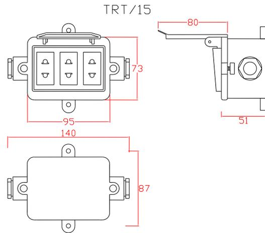
**CUERPO:** Estructura de aleación de aluminio. Stove bolts galvanizados de 5/32" Ø. Tomacorriente o Interruptores marca BTicino de 15 Amp. Pintura al horno color gris martillado.
